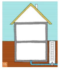
obturées et étanchées. Les passages de conduites (eau, électricité, gaz, etc.) devraient eux aussi être étanches.
