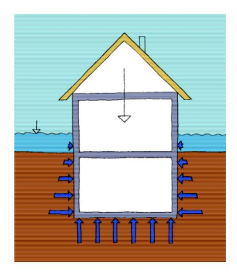
En cas de forte montée du niveau de la nappe phréatique ou lors d'inondations, d'énormes forces de poussée s'exercent sur le sol de la cave et sur les murs latéraux d'un bâtiment.
