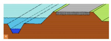
En cas de menace d'immersion des digues, celles-ci peuvent être rehaussées à l'aide de sacs de sable ou autres systèmes mobiles de barrage. Les voies de communication sont également d'une importance vitale en cas d'inon-
