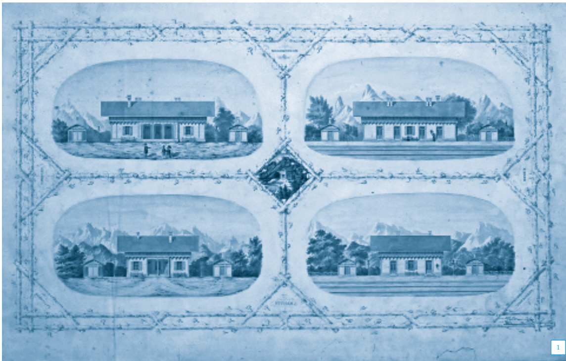
1 Kolorierte Typenzeichnungen von Ludwig Rudolf Maring im Schweizer Holzstil für die 1859 und 1860 eröffneten Linien Bern–Thun und Bern–Thörishaus der Schweizerischen Centralbahn. Plan: © SBB Denkmalpflege.
