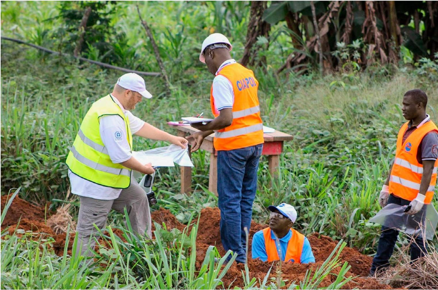
Prélèvement d'échantillons de sol à différentes profondeurs sur un des sites assainis à Abidjan.
