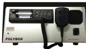
III. 14: Station fixe Polybox avec TPM700 Exemple du canton du Valais.
