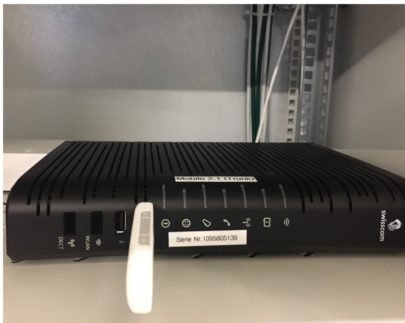
III. 44: Modem/Router SBCON Centro Business 2.0 Swiss avec stick USB pour 4G LTE.
