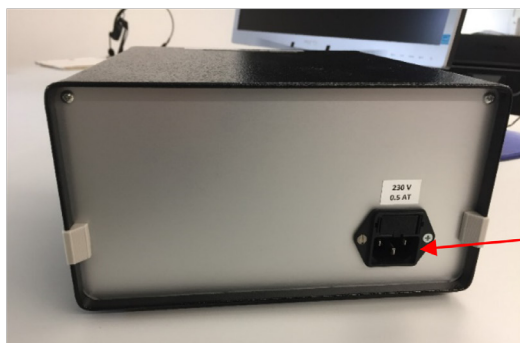
III. 63: Connexion du modem master NAG (à l'arrière).
