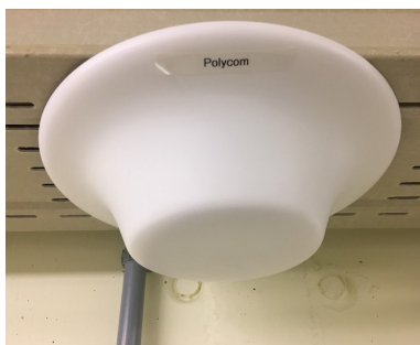
III. 36: Exemple d'une antenne Polycom omnidirectionnelle (à gauche) et d'une antenne omnidirectionnelle pour téléphonie mobile (à droite).
