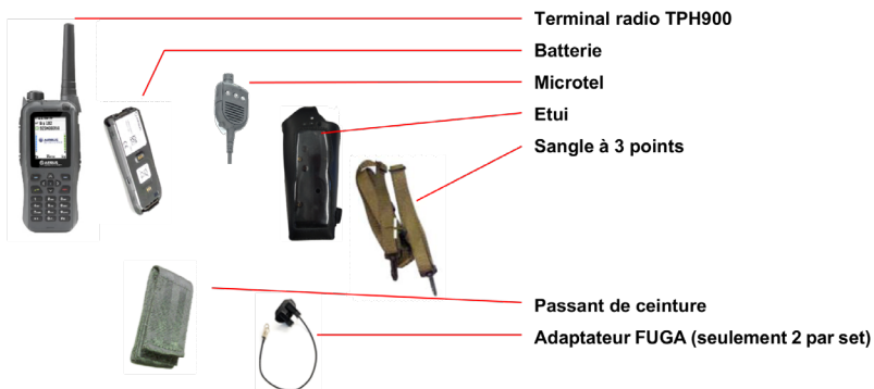
III. 23: Contenu de l'assortiment radios portables PCi 15.
